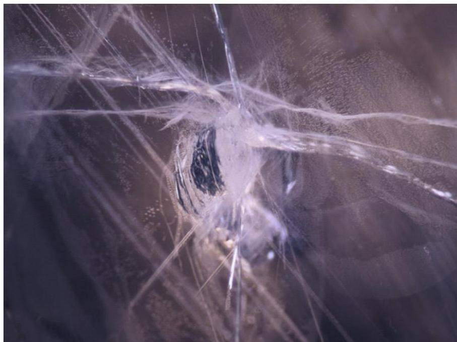
加压热处理后：处理过程中产生新裂缝，严重恶化透明度。
