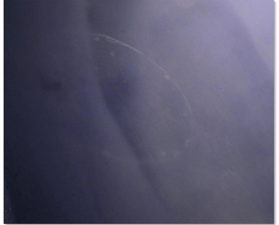
加压热处理后：一薄裂缝的愈合使透明度得到提高。
